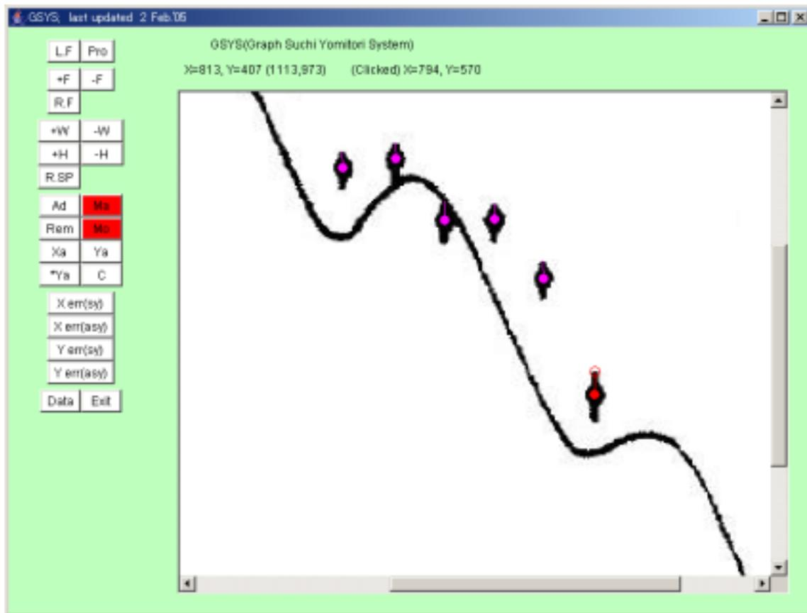
図5 データ点の入力（誤差棒有り）ここでは、Y方向の対称誤差がある場合。最後に設定したデータ点の誤差棒の先端には、誤差棒を微調整するための赤丸が表示されている。
